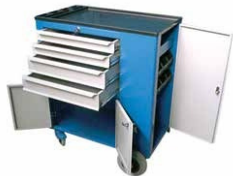
FECHADO C/ 4 GAVETAS - 1 PORTA LATERAL - 2 PORTAS FRONTAL - SUP CAIXAS BIN NA LATERAL - TAMPO VACUM FORMING (OPCIONAL) - RODIZIO: 2 FIXOS 8", 1 GIRAT, 1 GIRAT C/ FREIO 4"
