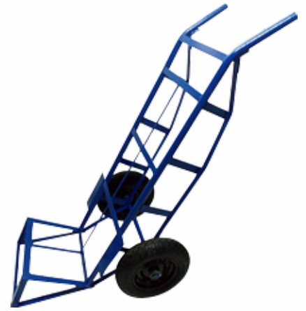
TC 402 CARRINHO DE MAO - REFORÇO INCLINADO - RODAS PNEUMATICAS 3.5 4 LONAS - CAPACIDADE DE CARGA 300KGS - SUPORTE NOS PÉS REFORÇADO
